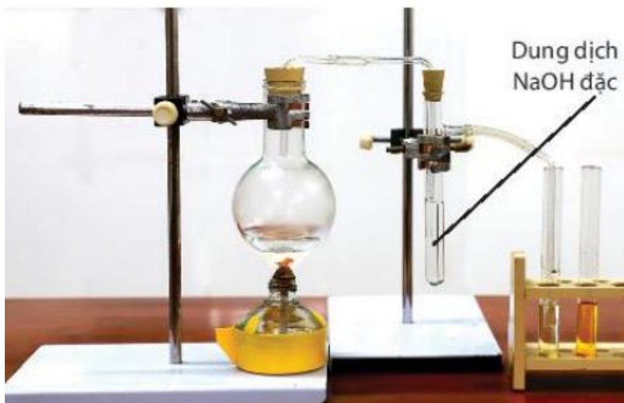
Điều chế và thử tính chất của ethylene trong phòng thí nghiệm
