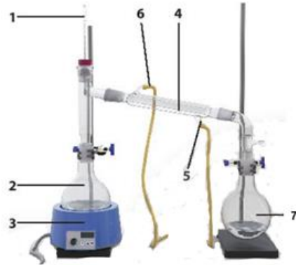
Hệ thống chưng cất đơn giản ở áp suất thường
